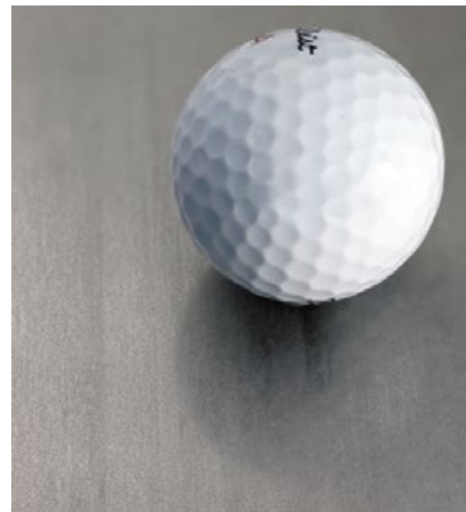
1D. Varmvalset, glødet, beiset
