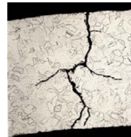
Spenningskorrosjonssprekker som har gått helt gjennom veggen til et rør i stålqualität EN 1.4307 som har vært utsatt for væskeholdig klorid i en varmeveksler.
