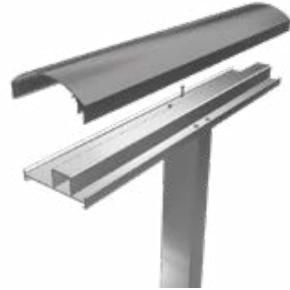
SKJULT INNFESTNING AV STOLPER TIL TOPPROFIL MED Ø38X32 MM SYREFASTE SKRUER I KLARGJORTE SPOR INNVENDIG I STOLPEPROFIL
