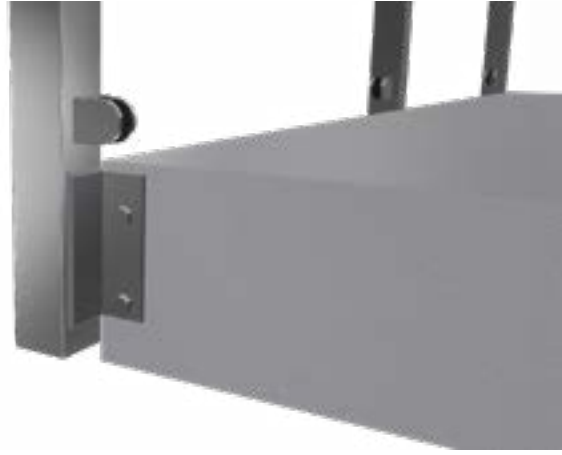
UTFØRSEL MED HJØRNESTOLPE I 60X60MM. VINKEL 50X50X5MM MONTERES MED 3 STK. Ø42X32 MM SYREFASTE SKRUER PÅ HVER SIDE
