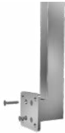
SKJULT INNFESTNING FOR SIDEMONTERTE STOLPE HVOR DET TRENGS AVSTAND FRA DEKKE FORKANT, MED SYREFASTE Ø38X42 MM SKRUER
