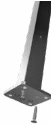
SKJULT INNFESTNING FOR TOPP MONTERTE STOLPE MED SYREFASTE Ø38X42 MM SKRUER
