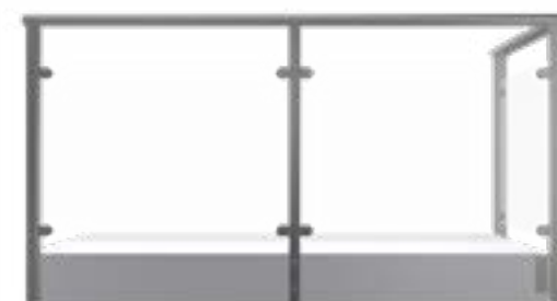
UTFØRSEL MED EN 60X60 HJØRNESTOLPE OG HÅNDLØPER. GLASSKLEMMER MED HERDET/LAMINERT GLASS.
